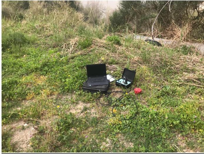
*Foto di postazione puntuale di sismica passiva HVSR*
