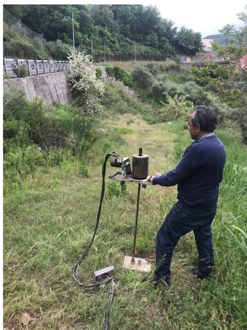
**Foto di prova penetrometrica dinamica continua**
